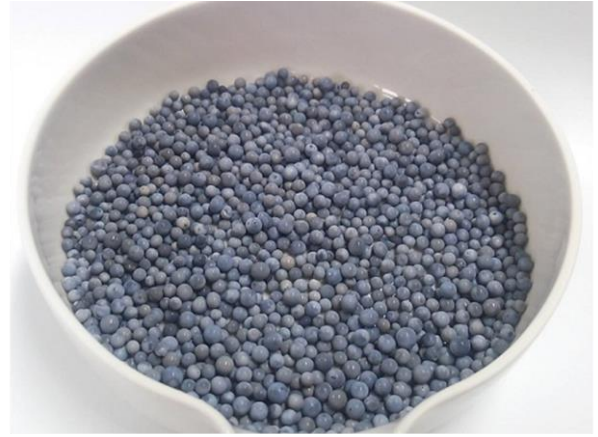
开发出的颗粒状疏水性铂催化剂（粒径 3mm）
